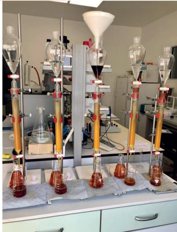
Nelle immagini soprastanti due momenti della lavorazione; nelle immagini sottostanti due momenti della rigenerazione delle colonne da cui si evince la quantità di sostanze scure eliminate dalla soluzione.
