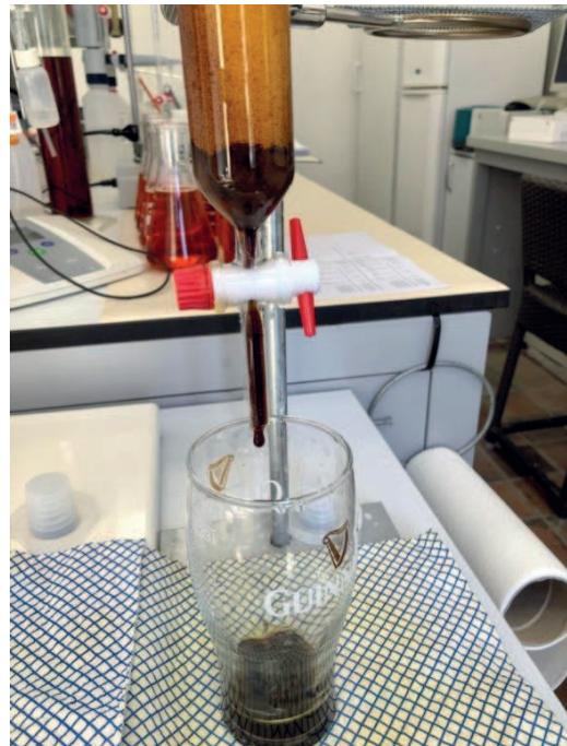
La soluzione parzialmente deionizzata è stata alimentata su tre colonne contenenti 250 ml circa cadasuna di resina cationica forte Purolite C150S. La resina era nuova e le colonne sono state sciacquate con 2 BV di acqua osmotizzata, messe in forma  $H^+$  con 4 BV di HCl 5% e risciacquate con 4 BV di acqua osmotizzata. Ogni colonna è stata alimentata con 750 ml (3 BV) di eluato 1 RAM1/M con una velocità di flusso di 3 BV/h. Si sono raccolti 2,25 l di soluzione avente l'analisi seguente:
